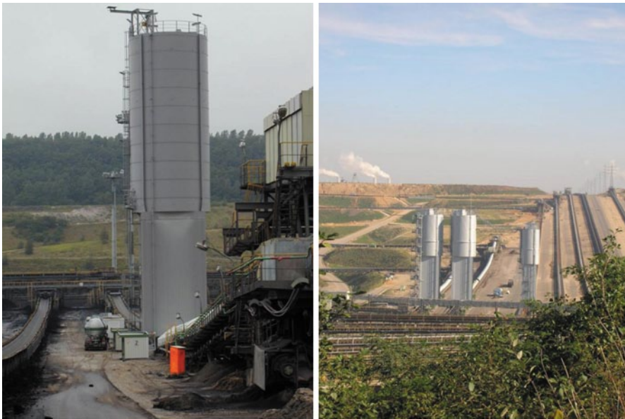
Abb. 7.10 Kalksilos zur Lagerung und Dosierung von gemahlenem Kalkstein im rheinischen Tagebau Garzweiler; der Kalk wird zur Erhöhung der pH-Pufferkapazität des Abraumes genutzt
