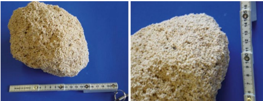
Abb. 3.15 Durch massive Kalkfällung im Filter verbackene Sandkörner bei der Aufbereitung von tiefem Grundwasser bis 500 m Entnahmetiefe („Filterverblockung“, Stadt Jin Cheng in der Provinz Shan Xi in China)
