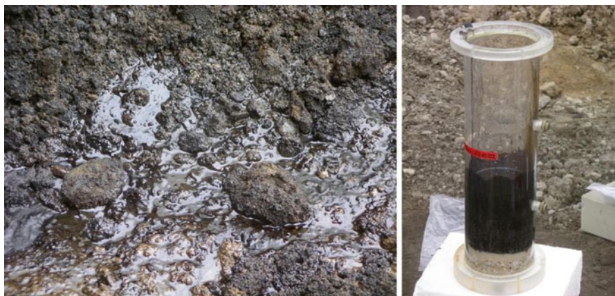
Abb. 4.18 Fotos des Austrittes von Teerölphasen ( links ) aus einem Grundwasserleiter in einer Baugrube und Einbau von diesen teerölbelasteten Sanden vom ehemaligen Gaswerksstandort Düssel-dorf-Flingern in Säulen ( rechts ) für Laborversuche
