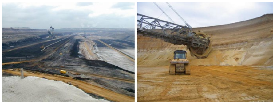
Abb. 7.8 Foto des Tagebaues Garzweiler mit der Abbauseite und Kippenseite ( links ) sowie Schaufelrad eines Baggers
